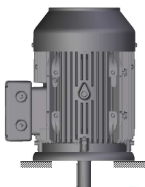
IM V1 IM 3011 kołnierz od strony napę- dowej, wałek skierowany w dół, bez łap
