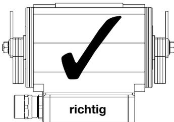
Die Anzahl der umgelegten Scheiben muss auf beiden Wellenenden symmetrisch erfolgen (s. Abb.). Zur Feineinstellung können auch Unwuchtscheiben entfernt werden, diese müssen durch Distanzscheiben ersetzt werden.
