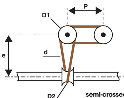
**D1** : roller bottom groove diameter
