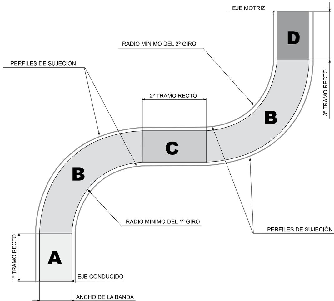
**A** - La longitud mínima del primer tramo recto debe ser 1,5 veces el ancho de la banda. Cuando por requerimientos de fabricación se necesite una longitud menor, ésta podrá ser igual al ancho de la banda, pero se deberá colocar un rodillo conducido en lugar de engranajes.
